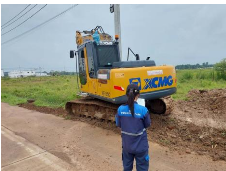
รูปที่ 2-21 การตรวจสอบเครื่องจักรก่อนการใช้งาน
