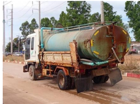
รูปที่ 2-14 การฉีดพรมน้ำบริเวณทางเข้าพื้นที่ก่อสร้าง
